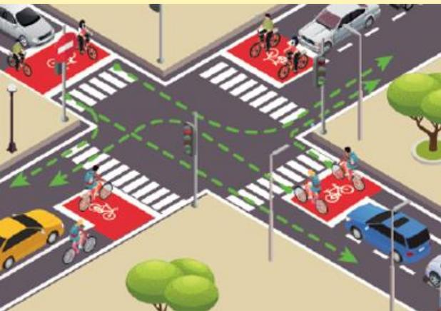
Presenza di una corsia o pista ciclabile lungo la strada. Prima erano richiesti 5 m di corsia o pista. Non essendo più specificata, la lunghezza minima del percorso ciclabile è lasciata alla valutazione del progettista, in relazione alle caratteristiche concrete del contesto dell'intervento.
